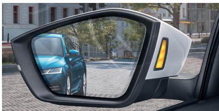
SIDE ASSIST Z REAR TRAFFIC ALERT Monitorowanie martwego pola
