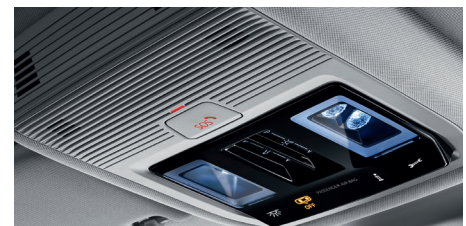
POŁĄCZENIE ALARMOWE Manualne lub automatyczne wezwanie pomocy po wypadku
