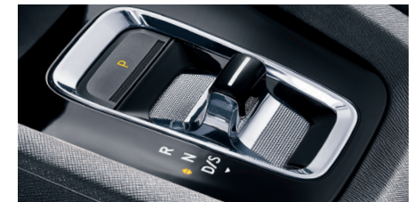
SHIFT-BY-WIRE Elektroniczne sterowanie skrzynią biegów DSG
