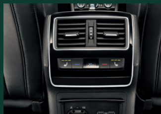
Climatronic automatyczna klimatyzacja trójstrefowa z regulacją elektroniczną
