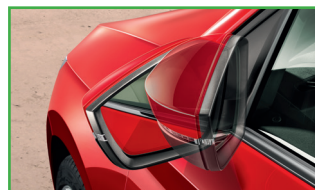
Elektrycznie sterowane, podgrzewane i składane lusterka boczne
