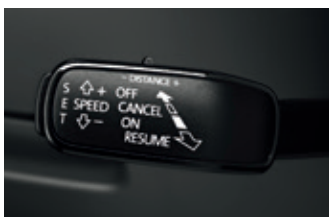
ADAPTIVE CRUISE CONTROL aktywny tempomat do 210 km/h z ogranicznikiem prędkości
