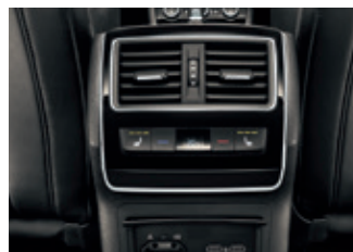
CLIMATRONIC automatyczna klimatyzacja trójstrefowa z regulacją elektroniczną
