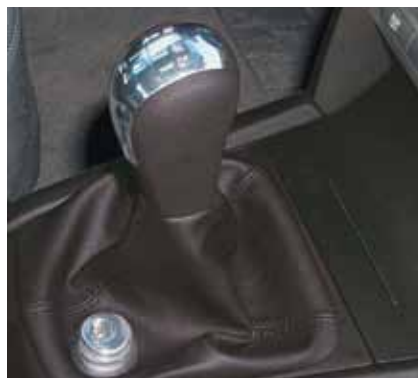
Mechaniczna blokada dźwigni zmiany biegów dla przekładni manualnej (1233Kp) – zdjęcie wykonane w innym modelu samochodu, dla przekładni automatycznej (DVC 630 002) – brak zdjęcia
