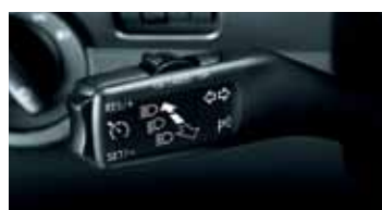
Tempomat do samochodów wyprodukowanych do 21. tygodnia 2010 r. (BEA 600 002A), od 22. tygodnia 2010 r.: z Maxi-DOT (3T0 035 623), bez Maxi-DOT (3T0 035 623A)
