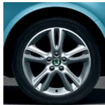
Obręcz koła ze stopów lekkich 6.5J x 16" Atria do opony 205/45 R16 (CCH 700 006)
