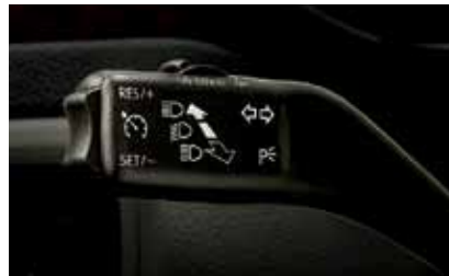
Tempomat dla samochodów wyprodukowanych po 22 tygodniu 2010 r. Ze sterowaniem komputera pokładowego (3TO 035 623) lub bez sterowania (3TO035 623A)
